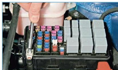
...головкой «на 10» отворачиваем гайку.
