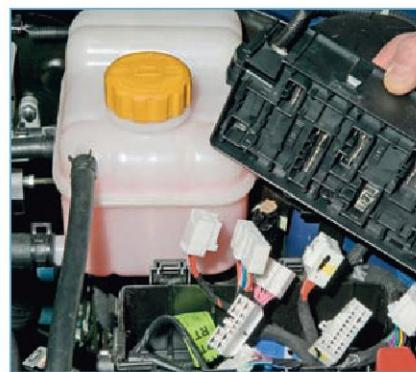
Снимаем монтажный блок.
