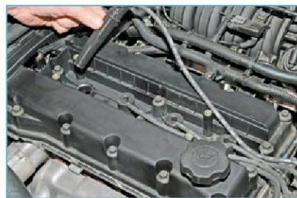
Снимаем со свечи наконечник высоковольтного провода.
