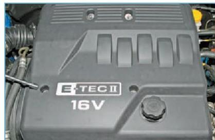
Головкой «на 10» отворачиваем две гайки и два болта крепления крышки двигателя и снимаем ее.
