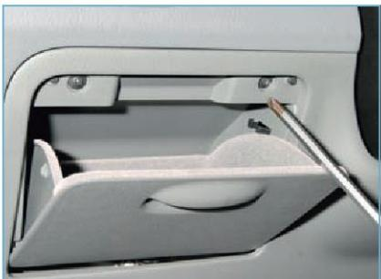
...открыв ящик для монет, крестообразной отверткой отворачиваем два самореза.
