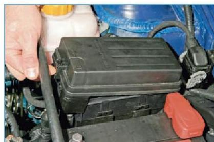
...нажав пластмассовую защелку, снимаем крышку монтажного блока.
