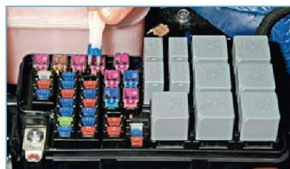
Пинцетом извлекаем предохранитель.
