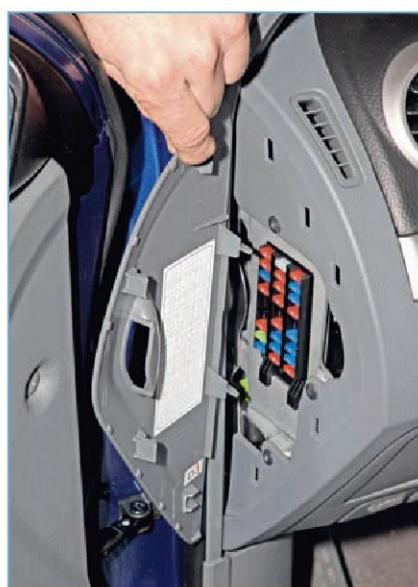
...снимаем крышку в левом торце панели приборов.
