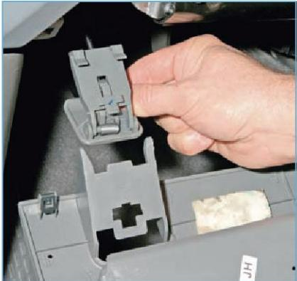
...освобождаем рукоятку привода замка капота и снимаем нижнюю облицовку.
