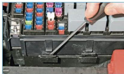
Отверткой отжимаем два фиксатора с одной стороны блока и два с другой...
