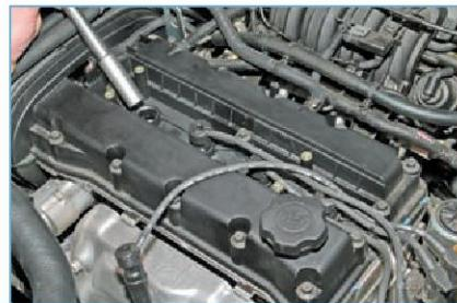
Высокой «свечной» головкой «на 16» с удлинителем выворачиваем свечу зажигания и вынимаем ее из свечного колодца.
