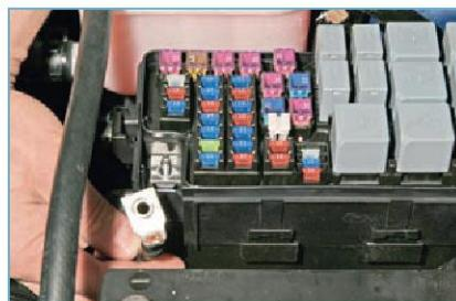
Снимаем со шпильки наконечник провода.
