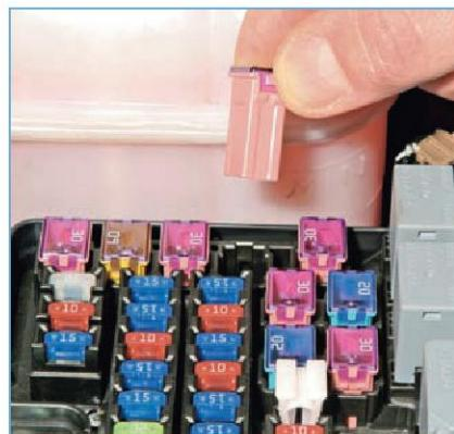
Предохранитель большого размера вынимаем из блока рукой.
