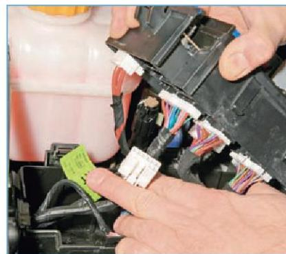
...и приподняв блок, отсоединяем от него колодки проводов.
