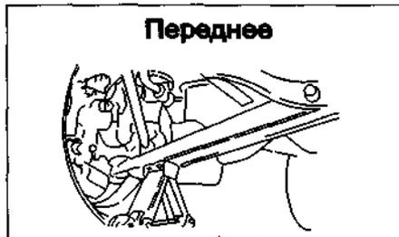
**ВНИМАНИЕ!** При использовании домкрата удостоверьтесь, что автомобиль поднимается в вертикальном направлении. В случае перекоса домкрата следует вернуть его в исходное положение, выровнять и повторить подъем. Никогда не поднимайте домкратом автомобиль на наклонной поверхности.
